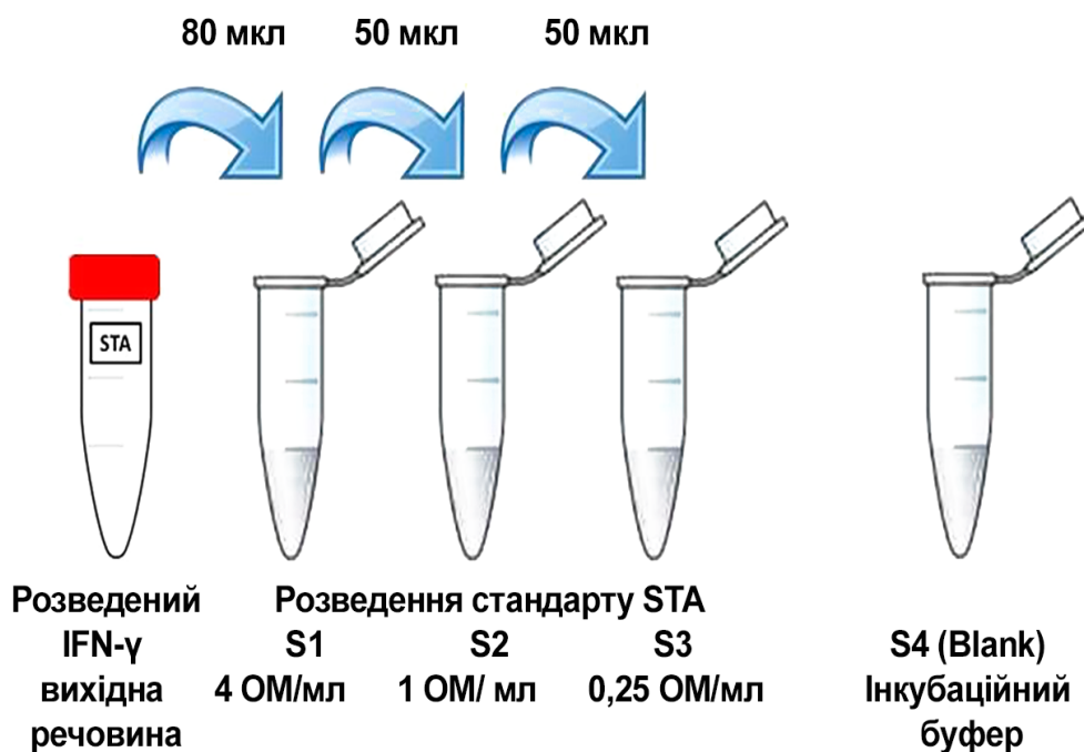
Малюнок 1: Приготування стандартів різних концентрацій IFN-γ S1 - S3.
